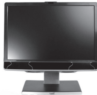
図11 質問画面実験で使用された非接触型アイトラッカー Tobii T60XL (アイトラッカーと24インチ・モニタスクリーンの一体型) (画像使用許諾：トビー・テクノロジー株式会社)
