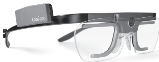
図7 ウエアラブルタイプのアイトラッキング装置 (Tobii Pro Glasses 2) (画像使用許諾: トビー・テクノロジー株式会社)
