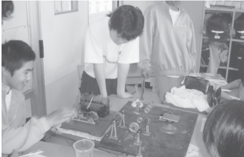
「工場模型の運転 蒸気機関が各種の工作機械を動かす」
