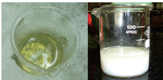
図1 硫安溶液の添加前後での卵白溶液の変化 左：卵白溶液（溶液中の白い物体は撈拌子） 右：硫安溶液添加後、卵白タンパク質の白色沈殿が生じた卵白溶液
