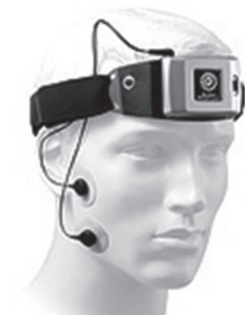
図1： Sleep Profiler (脳波記録簡易睡眠検査装置) 装着すると音声による操作案内が流れる。バッテリー込みで約72グラム、記録時間は15時間である。
