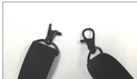
図4 破損したショルダーベルトのフック
